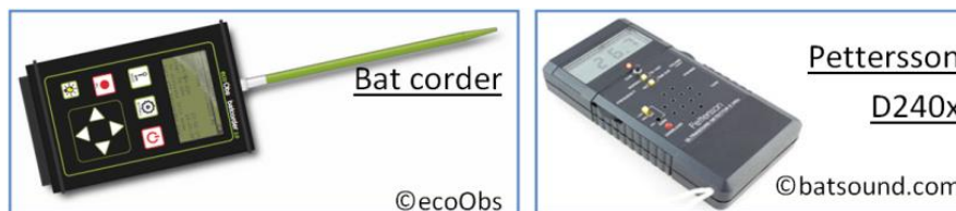
Figure 4 : Détecteur d'ultrason manuel et enregistreur automatique pour les chiroptères
